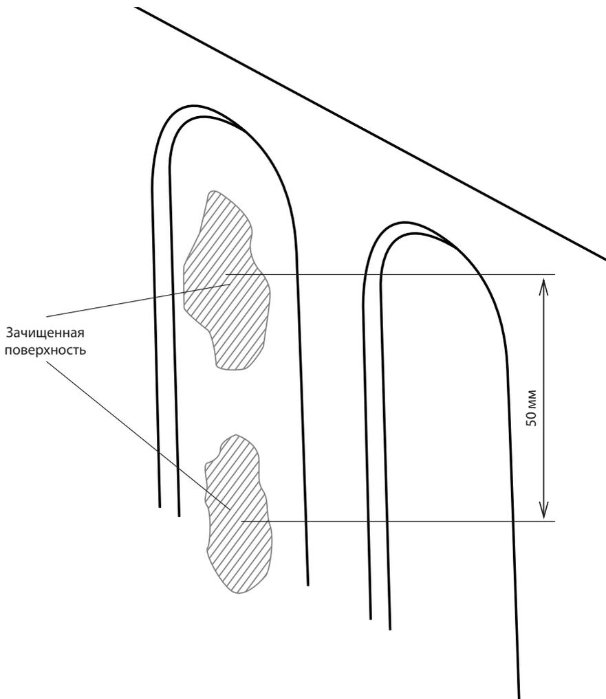
**3. Установить на пистолете расстояние между захватами для приварных шпилек 50 мм.**
