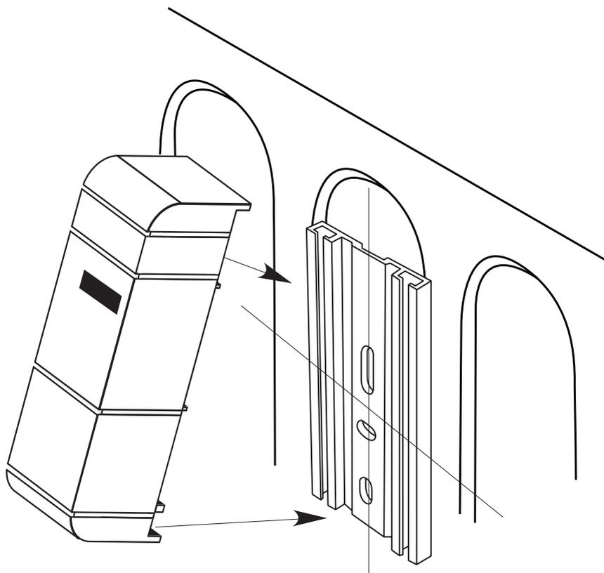
**Отопительный прибор с установленным счетчиком-распределителем тепла INDIV-X-10(R).**
