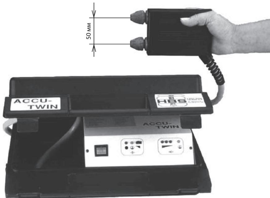
**4. Приварить две шпильки на поверхность радиатора с помощью сварочного пистолета ACCU-TWIN, следуя инструкции сварочному пистолету и соблюдая места монтажа шпилек (стр. 2), и закрепить тепловой адаптер на шпильках двумя гайками М3.**
