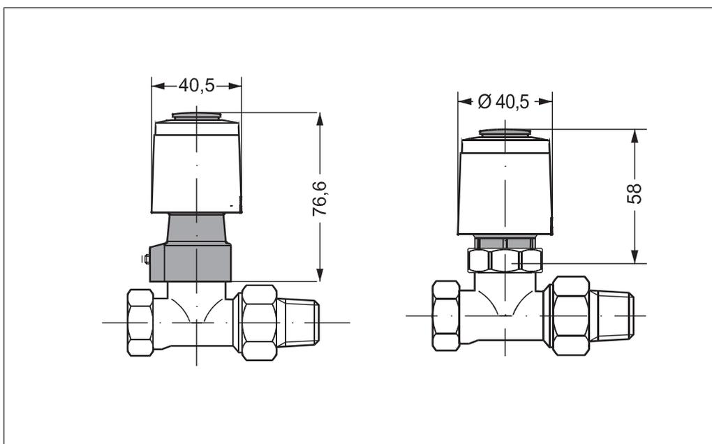
**Внимание!** Все нормально закрытые термоэлектрические приводы перед монтажом должны быть приведены в открытое положение (красный фиксатор установлен на привод) для их легкой установки на клапан.
