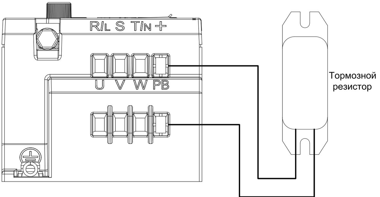
Рисунок 3.3-1 Подключение тормозного резистора для преобразователей частоты RF-51
