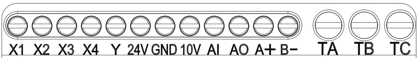
Рисунок 3.2-3 Расположение клемм цепи управления преобразователей частоты мощностью 0,4–5,5 кВт
