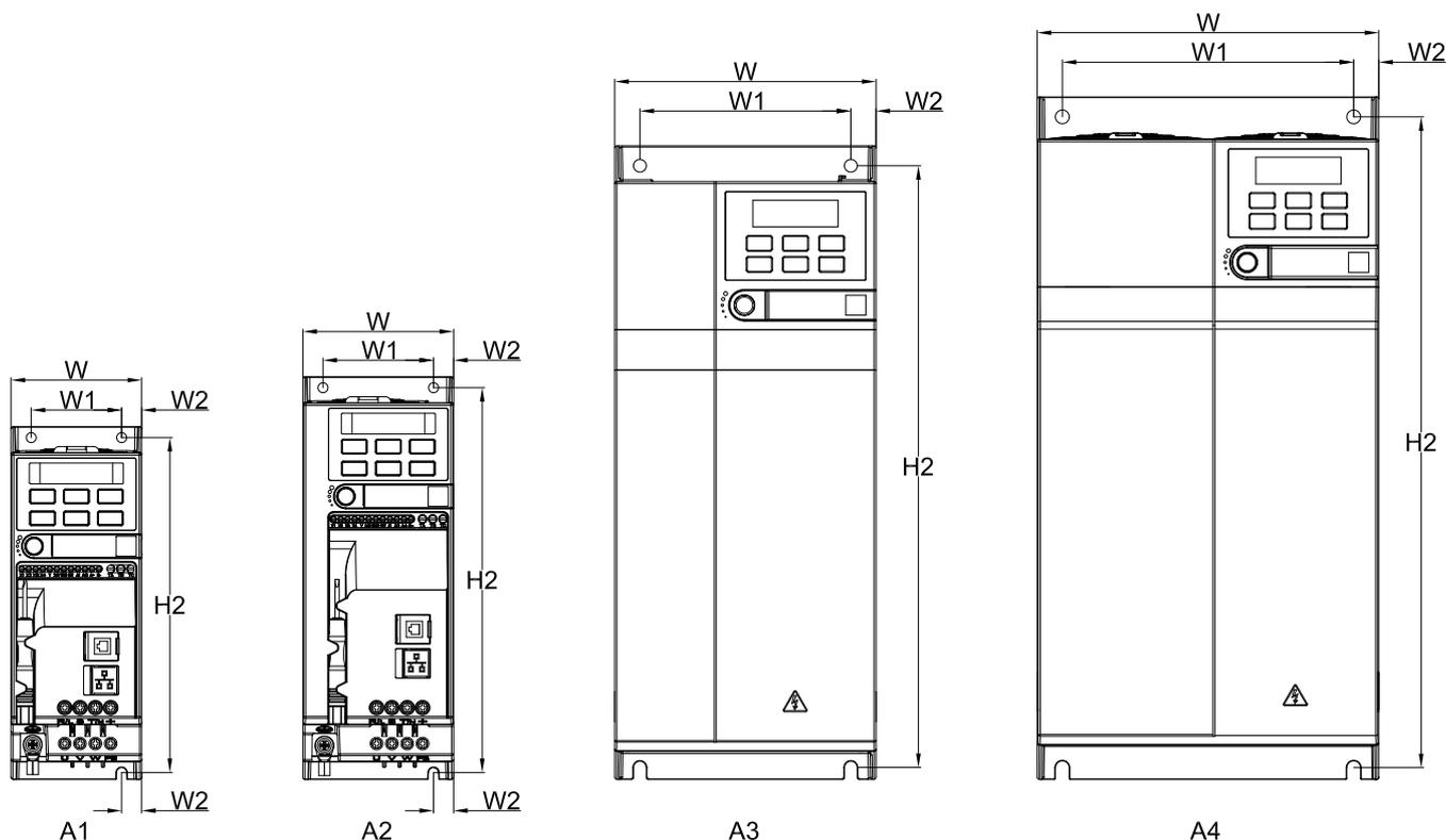
Рисунок 2.1-1 Типоразмеры преобразователей частоты
