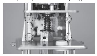
3. На стойки при помощи четырех винтов смонтировать плату с кулачками. Зубья вала платы должны попасть на зубья штока.
