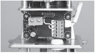
4. Подключить плату к клеммам привода:
