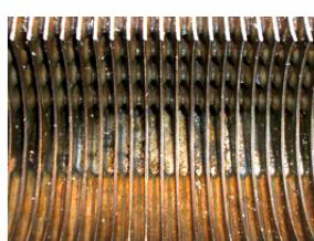
а вещества, диссоциирующие на ионы (IV), находятся в теплоносителе в растворенном состоянии, но откладываются на поверхности теплообменника при определенной температуре стенки (накипь). Остальные типы загрязнений проходят теплообменный аппарат транзитом.
