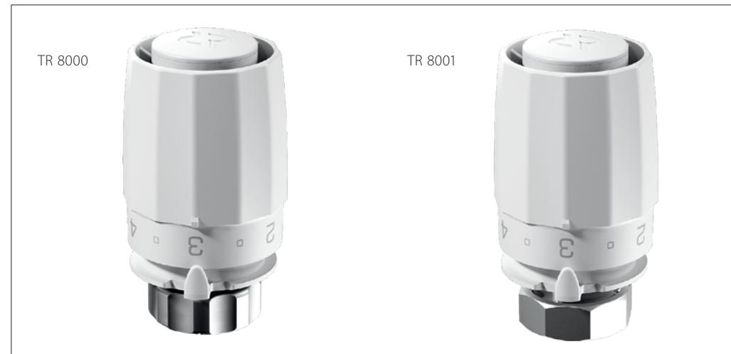
Термостатические элементы серии TR 8000 — устройства автоматического регулирования температуры, предназначенные для комплектации радиаторных терморегуляторов Ридан TR-N и TR-G, а также Danfoss RA-N/G и RTR-N/G. Имеют присоединение M30x1,5 для термоэлемента TR 8001 и присоединение RTR/RA для TR 8000, совместимые с клапанами Danfoss.
