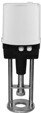
Электропривод AMV(E)-10KR предназначен для управления регулирующими клапанами Ридан VFM-2R VF-2R DN 300 и VF-3R DN 100–300. Управление приводом Ридан AMV-10KR осуществляется по импульсному/аналоговому сигналу от электронных регуляторов Ридан типа ECL-3R/4R или подобных. Привод АМЕ-10KR управляется по импульсному/аналоговому сигналу от контроллера, который поддерживает такой тип управления.
