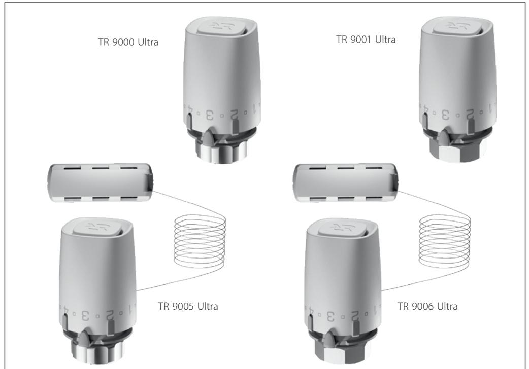
Термостатические элементы серии TR 9000 Ultra — устройства автоматического регулирования температуры, предназначенные для комплектации радиаторных терморегуляторов Ридан TR-N и TR-G а так же Danfoss RA-N/G и RTR-N/G. Имеют присоединение M30x1,5 для термоэлемента TR 9001 Ultra и TR 9006 Ultra и присоединение RTR/RA для TR 9000 Ultra и TR 9005 Ultra, совместимые с клапанами Danfoss.
