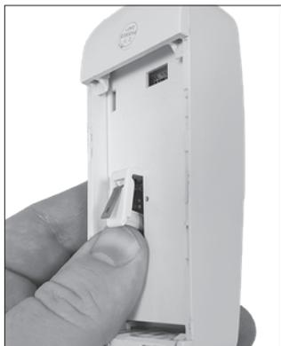
4). Нажать на пластиковый рычаг кнопки контроля вскрытия еще раз не менее, чем на 10 секунд.
