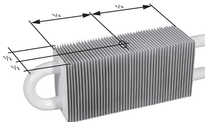
③ Изогните резьбовую шпильку М3х330 и проденьте ее между ребрами конвектора «Универсал».
