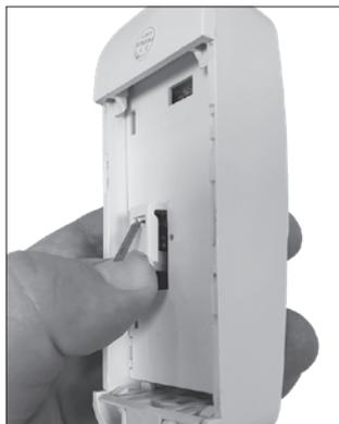
5). Затем пластиковый рычаг кнопки можно отпускать – распределитель переведен из режима «Sleep» в режим монтажа.
