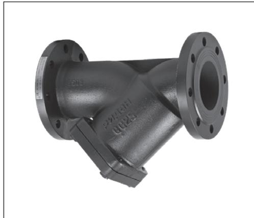
Фильтр сетчатый Ридан-ФСФ предназначен для установки перед регулирующей арматурой, расходомерами, насосами с «мокрым» ротором электродвигателя и другими устройствами с повышенными требованиями к чистоте проходящей через них воды в системах отопления, теплоснабжения, технического горячего и холодного водоснабжения, а также для механической очистки рабочей среды от грязи, ржавчины, стружки и т. д. в пределах эксплуатационных характеристик изделия и примененных материалов.
