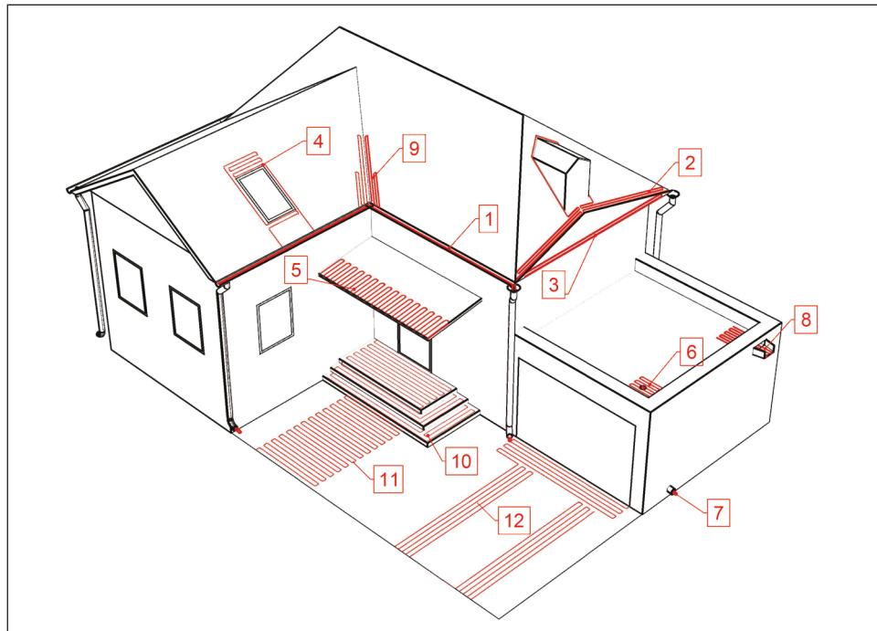
Рис. 1. Варианты использования кабеля Ridan Snow-30 для уличных систем снеготаяния
