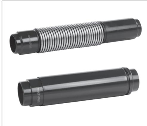
Осевые компенсаторы Ридан предназначены для компенсации температурных удлинений трубопроводов систем горячего водоснабжения, отопления, а также трубопроводов промышленных систем с жидкими средами, которые неагрессивны к конструкционным материалам компенсаторов.
