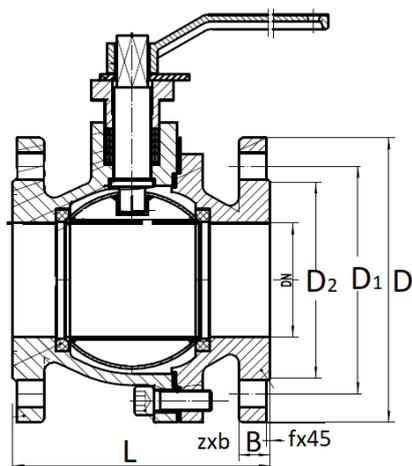
Габаритные и присоединительные размеры кранов шаровых типа КШЧ.
