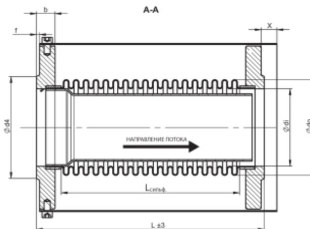
Осевой компенсатор с внутренней гильзой и наружным кожухом.
