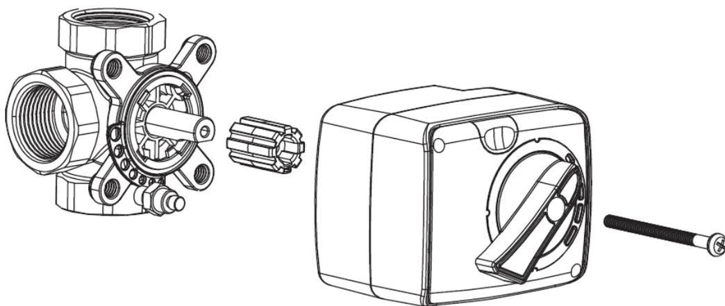
Схема монтажа привода с моментом 10Нм на клапан HRB-3R/HFE-3R
