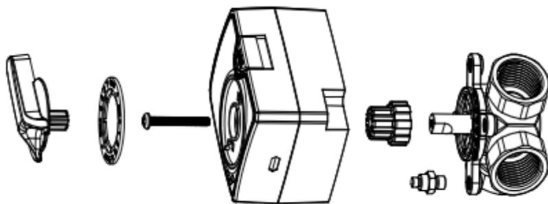
Монтаж привода на клапаны AMZ-112/113R осуществляется в аналогичном порядке, за исключением штифта, вместо штифта используется соответствующий мост, монтирующийся на ISO фланец клапана.
