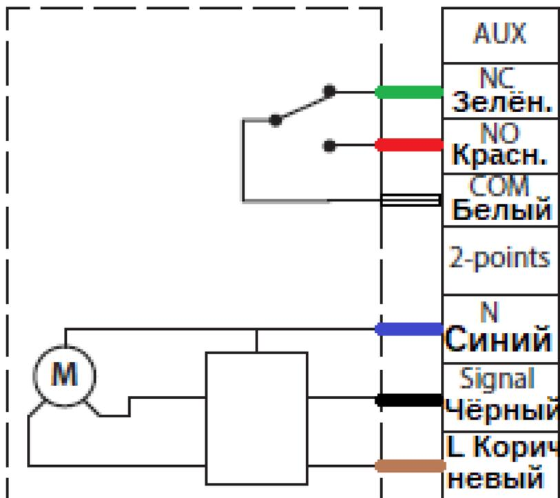
**Управление 2-х позиционным приводом:** при подаче сигнала управления (черный провод) и наличии общего питания, привод вращается по часовой стрелке до достижения крайнего положения, после чего останавливается, и находится в крайнем положении. При снятии сигнала управления, и наличии общего питания, привод возвращается в исходное положение.
