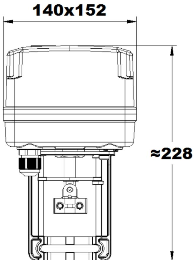
Привод имеет один кабельный ввод М18\*1,5 для кабеля 5-10мм.
