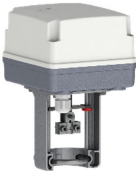
Электропривод ARV(E)-1000R SU/SD предназначен для управления регулирующими клапанами VFM-2R (через адаптер)\*, VF-3R, VF-2R с диаметром DN15–50. Управление приводом Ридан ARV-1000R SU/SD, осуществляется по импульсному сигналу от электронных регуляторов Ридан типа ECL-3R/4R или подобных.
