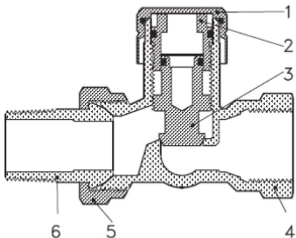
Клапан LV - конструкция: 1) Крышка; 2) Направляющая втулка; 3) Запорный конус; 4) Корпус клапана; 5) Соединительная гайка; 6) Нипель.
