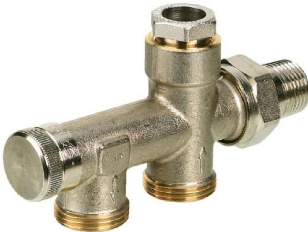
Клапан запорный тип LV, модификации LV-К предназначен для использования в качестве соединительного элемента и запорного клапана в составе присоединительно-регулирующей гарнитуры TR-К. Гарнитура TR-К используется для присоединения отопительных приборов с боковым подключением в двутрубных насосных системах водяного отопления с подпольной прокладкой
