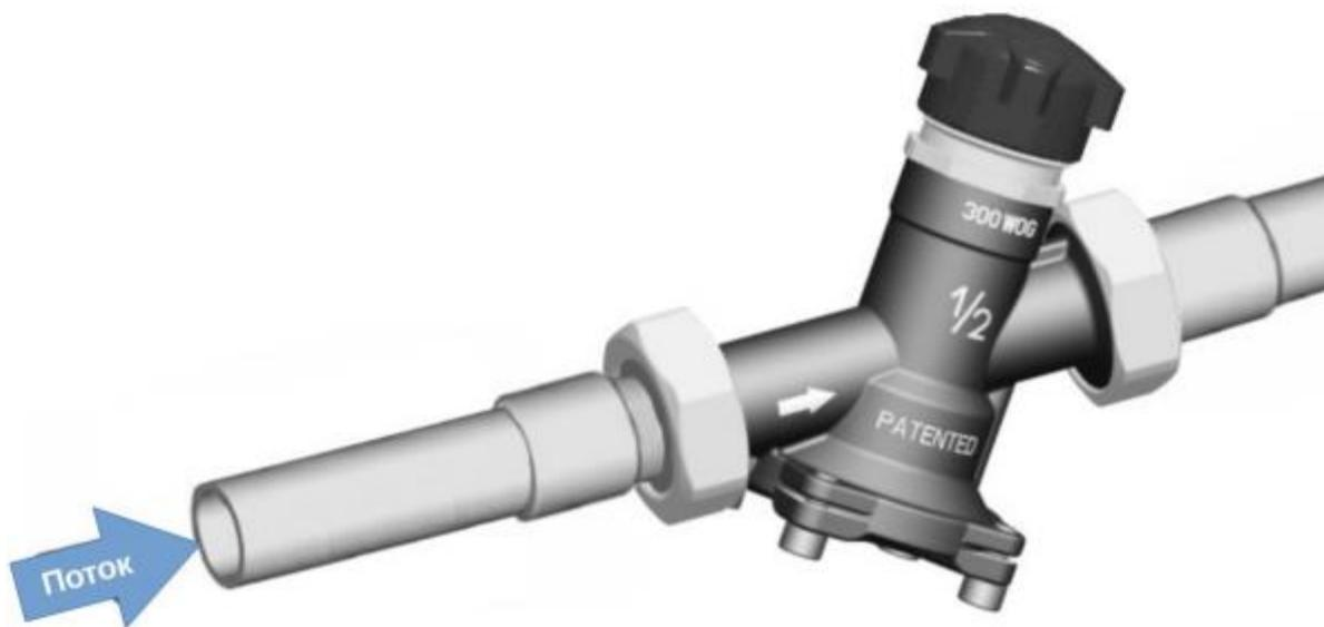
При установке клапана направление стрелки на его корпусе должно совпадать с направлением потока. Если условие не выполняется, то клапан будет функционировать некорректно. Если на клапан будет установлен привод, то клапан нельзя монтировать штоком вниз.
