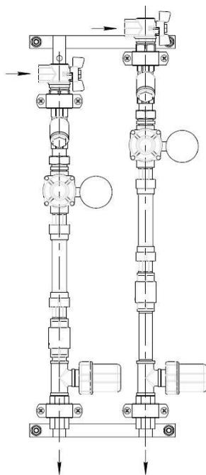
Квартирная станция водоснабжения типа ШКСВ-1Р предназначена для подключения к стоякам ХВС/ГВС системы водоснабжения. При применении квартирных станций водоснабжения типа ШКСВ-1Р выполняются присоединительная, измерительная, и регулирующая функции.
