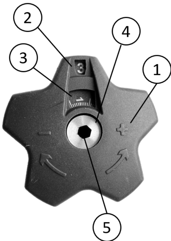
Настройка производится с помощью рукоятки без использования дополнительных инструментов. Вращая рукоятку по часовой значению пропускной способности уменьшается, против часовой увеличивается.
