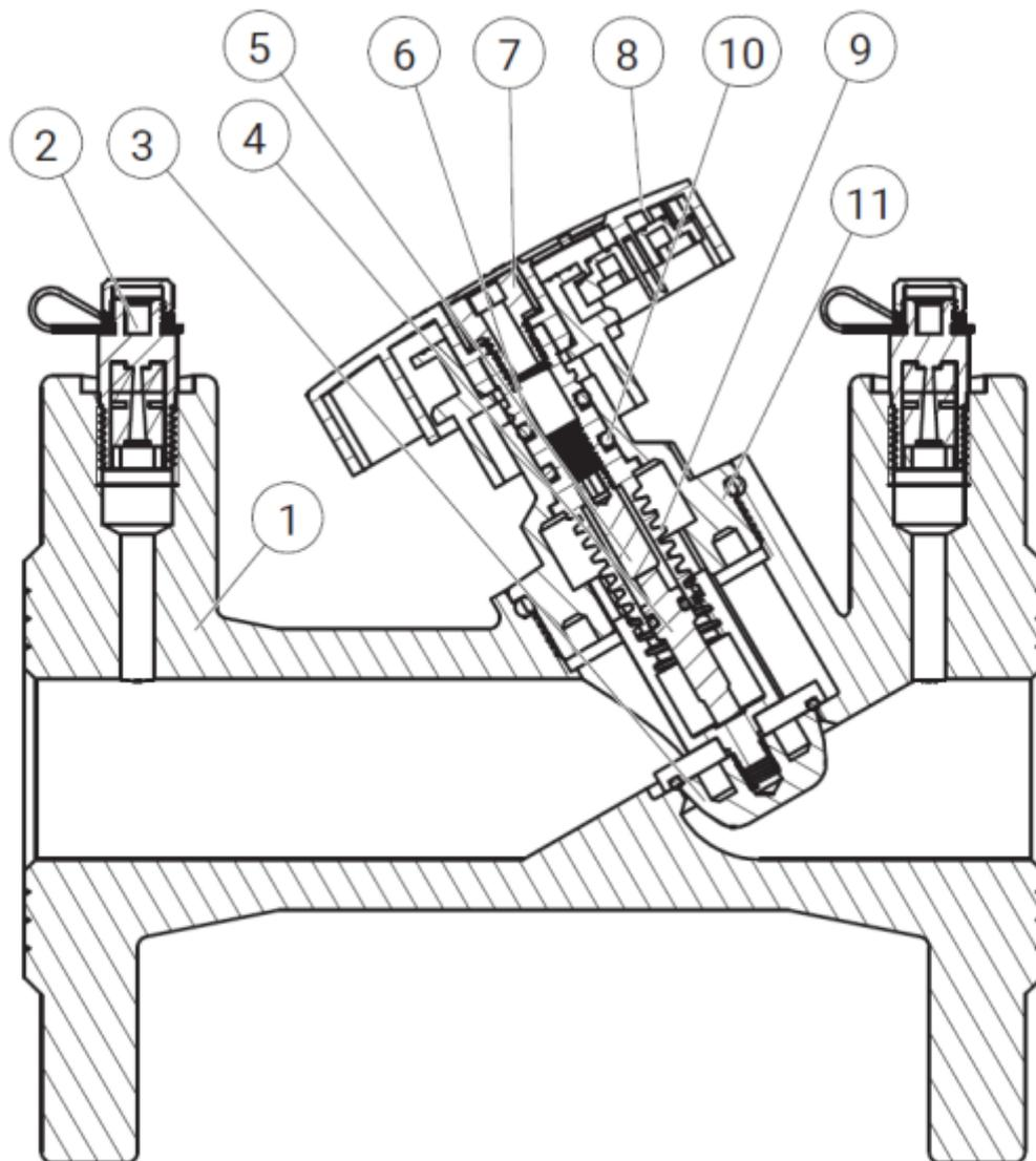
1. Корпус. 2. Измерительный ниппель. 3. Конус. 4. Шток. 5. Штифт. 6. Кольцевое уплотнение. 7. Рукоятка. 8. Винт. 9. Шпиндель. 10. Сальник. 11. Крышка корпуса
