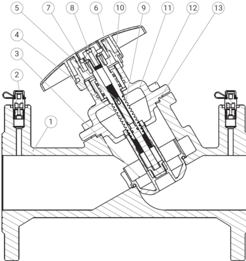
1. Корпус. 2. Измерительный ниппель. 3. Конус. 4. Шток. 5. Штифт. 6. Кольцевое уплотнение. 7. Рукоятка. 8. Винт. 9. Шпиндель. 10. Сальник. 11. Крышка корпуса. 12. Болт. 13. Прокладка.
