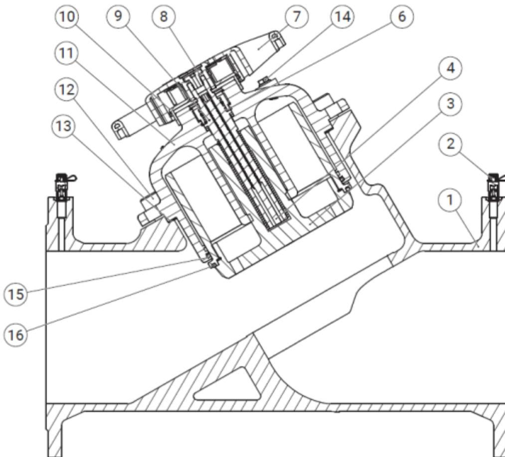
1. Корпус. 2. Измерительный ниппель. 3. Конус. 4. Шток. 5. Штифт. 6. Кольцевое уплотнение. 7. Рукоятка. 8. Винт. 9. Шпиндель. 10. Сальник. 11. Крышка корпуса. 12. Болт. 13. Прокладка. 14. Болт. 15. Кольцевое уплотнение. 16. Кольцевое уплотнение.
