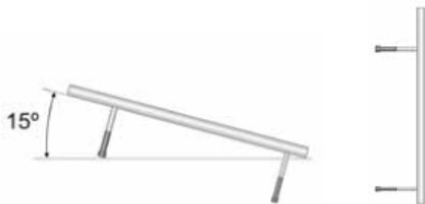
Монтаж теплообменников микроканальных типа MCHE
