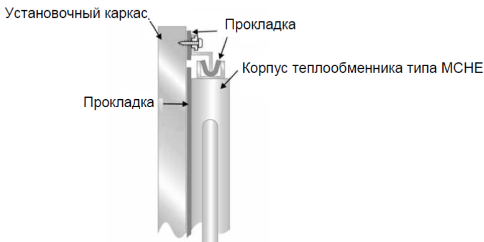
Монтаж теплообменников микроканальных типа MCHE.
