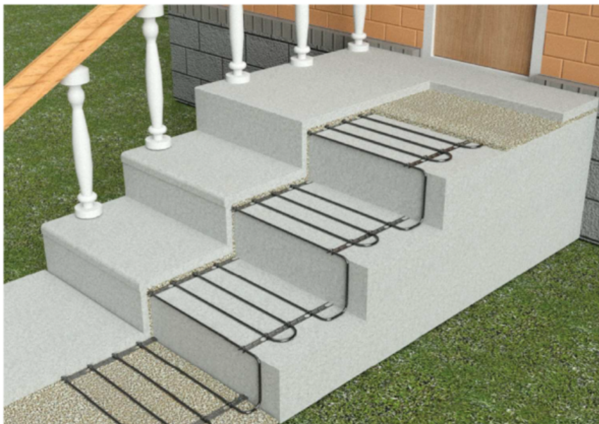
Монтаж нагревательного кабеля на ступенях крыльца.
