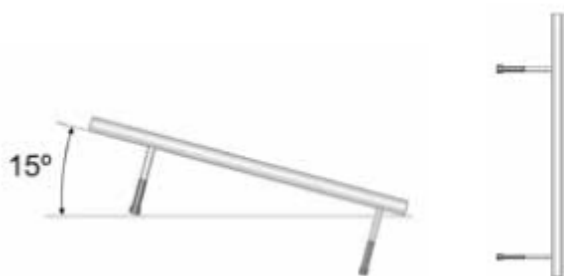
Монтаж теплообменников микроканальных типа МСНЕ
