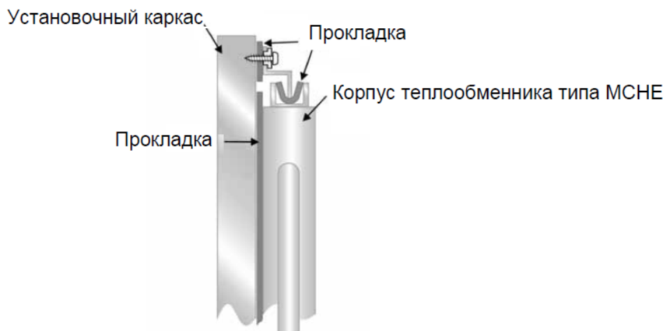
Монтаж теплообменников микроканальных типа MCHE.
