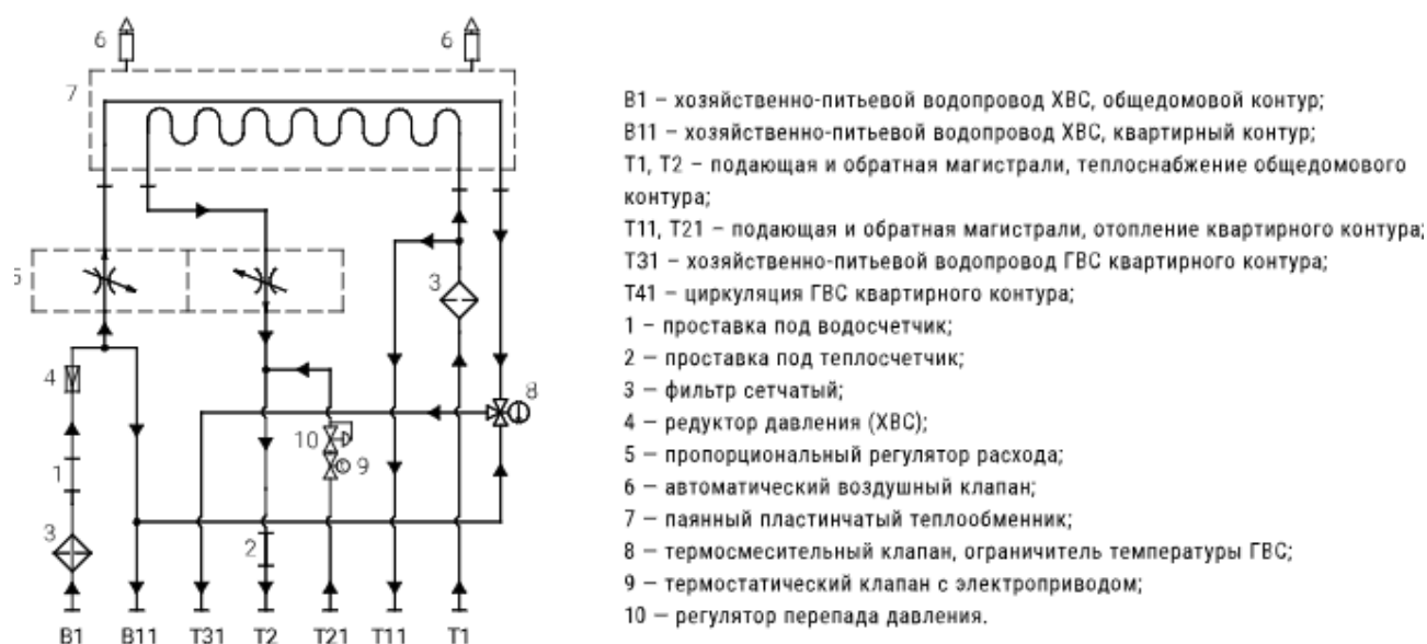
Рисунок 1. Гидравлическая схема MyFlat MF-101
